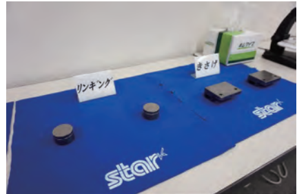
製造工程で鍵となるリング、きさげ。ミクロン単位の平滑を如何に保つか、人の技が欠かせない
