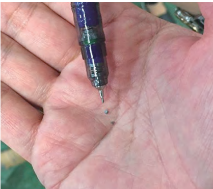
生産されている精密ネジ。精密機器・情報端末で使用
